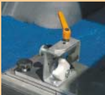
Lagerbock zur Arretierung der Rampe im Innenraum.
